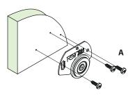
Instalação da guia superior retrátil (Opção de fixação frontal ou superior)
